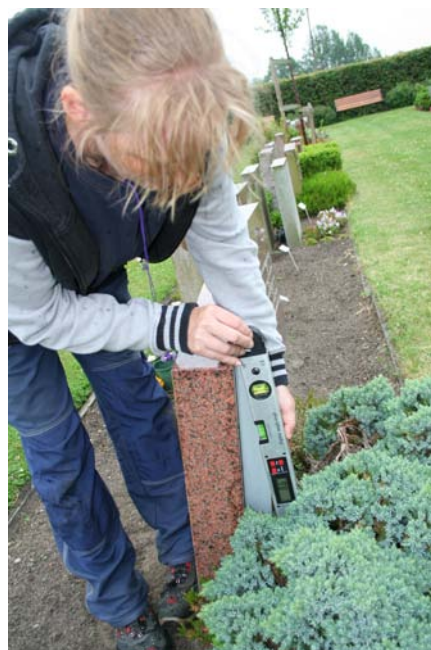
Figur 4. Kontroll av lutning med vinkelindikator.
